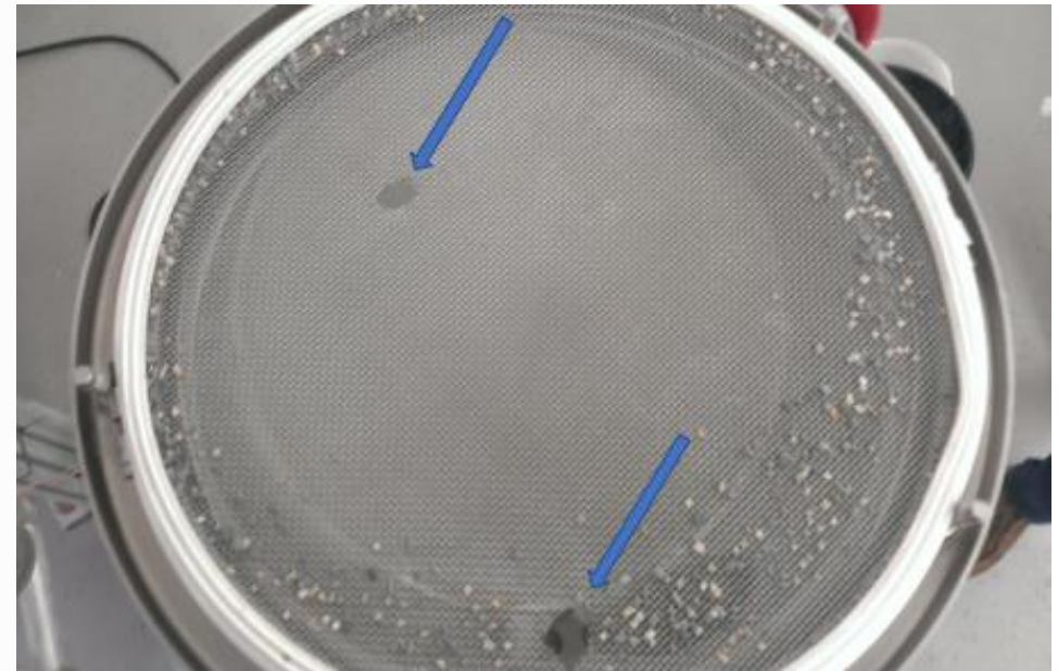
Após o rompimento da peneira partículas de maior tamanho passam pelo furo
